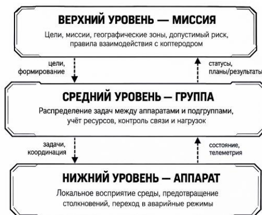
Рисунок 2 – Трёхуровневая архитектура управления роем БПЛА
